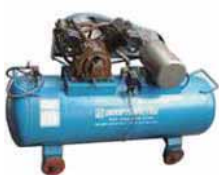
39-17 Air Compressor(10HP) G-39-1901 에어 콤프레서
